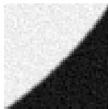
Drehachse liegt um 0,5 Pixel daneben.
