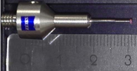
Ansicht des Tasters mit Materialauftrag in Originalgröße.
