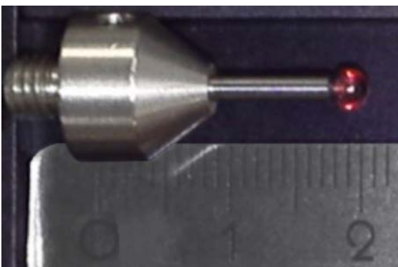
Ansicht des abgenutzten Tasters in Originalgröße.
