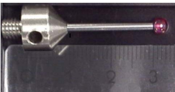
Ansicht des defekten Tasters in Originalgröße.
